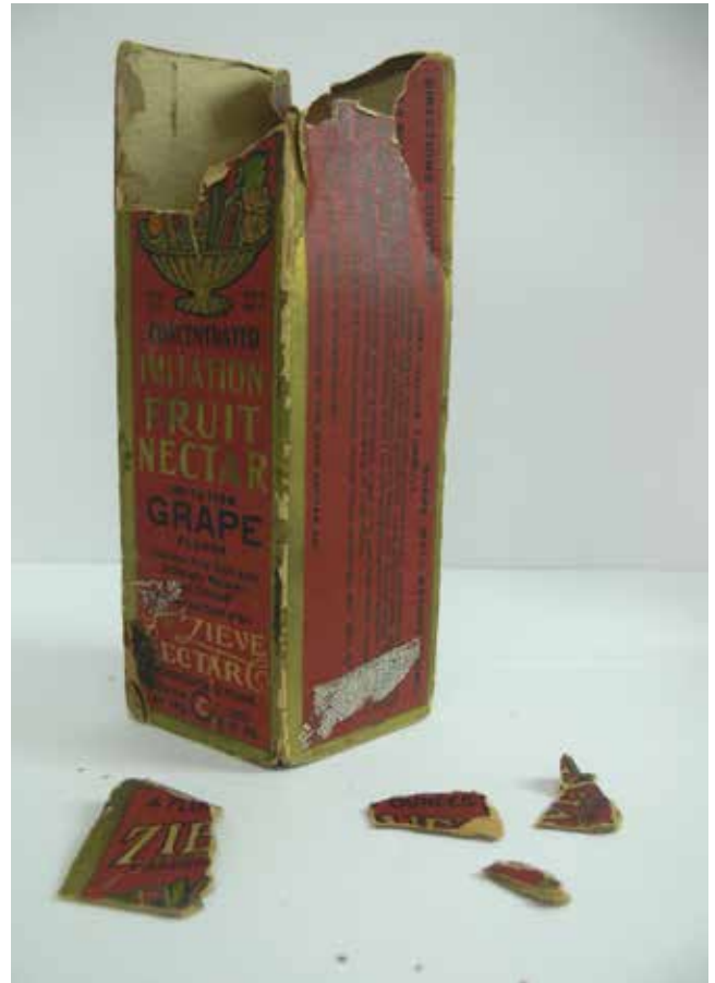
קופסה עשויה קרטון עם הדפסת צבע. נראים שברים, קרעים וחוסרים בתוצאה מחומציות הקרטון ומהתנהלות לא זהירה
