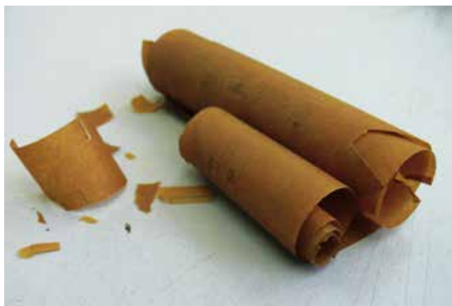
שרטוט מגולגל - נייר ההעתקה חומצי מלכתחילה, ועם הזמן נעשה שברירי מאוד. צילומים: נעה כהנר סקמנוס
